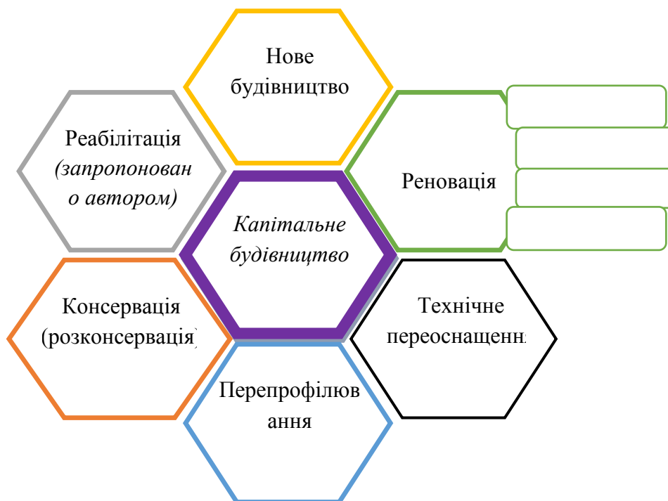
Рис. 1. Види капітального будівництва
