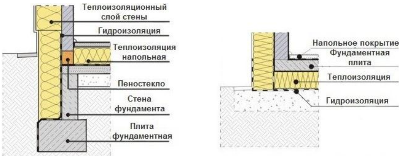
Рис. 1. Схема принципу герметизації пасивної будівлі
